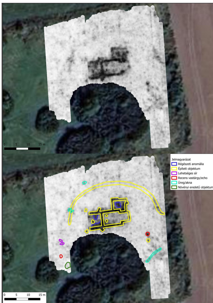
5. kép. A varjaskéri templom területén végzett földradaros felmérés eredménye (a felszíntől számított egy méteres mélységszelvényen), valamint a mérés értelmezése (Stibrányi Máté, Munifex Kft.)
