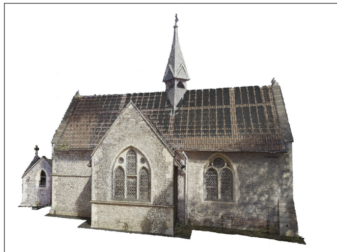
10. kép. A Feriköyi Protestáns Temető kápolnájáról TLS-szkennerrel készült pontfelhő (Készítette: Kovács Máté Gergő, 2021)
