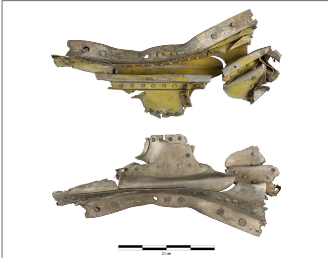
3. kép: A szárnyból származó darab, amelyen jól látszik az amerikai gyártást felismerhetővé tévő alapozó (fotó: György László, MNM NRI)
