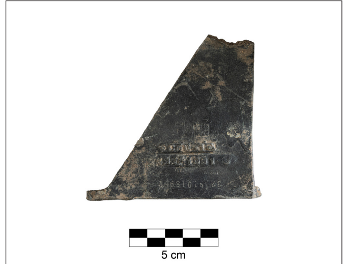
4. kép: A GK32P1089 kód alapján ez a darab az egyik motor vezérlésénél lévő konzolból származik (fotó: György László, MNM NRI)
