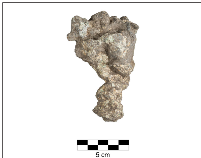
7. kép: A magas hőfokú égést jelzi az összeolvadt alumíniumdarab (fotó: György László, MNM NRI)
