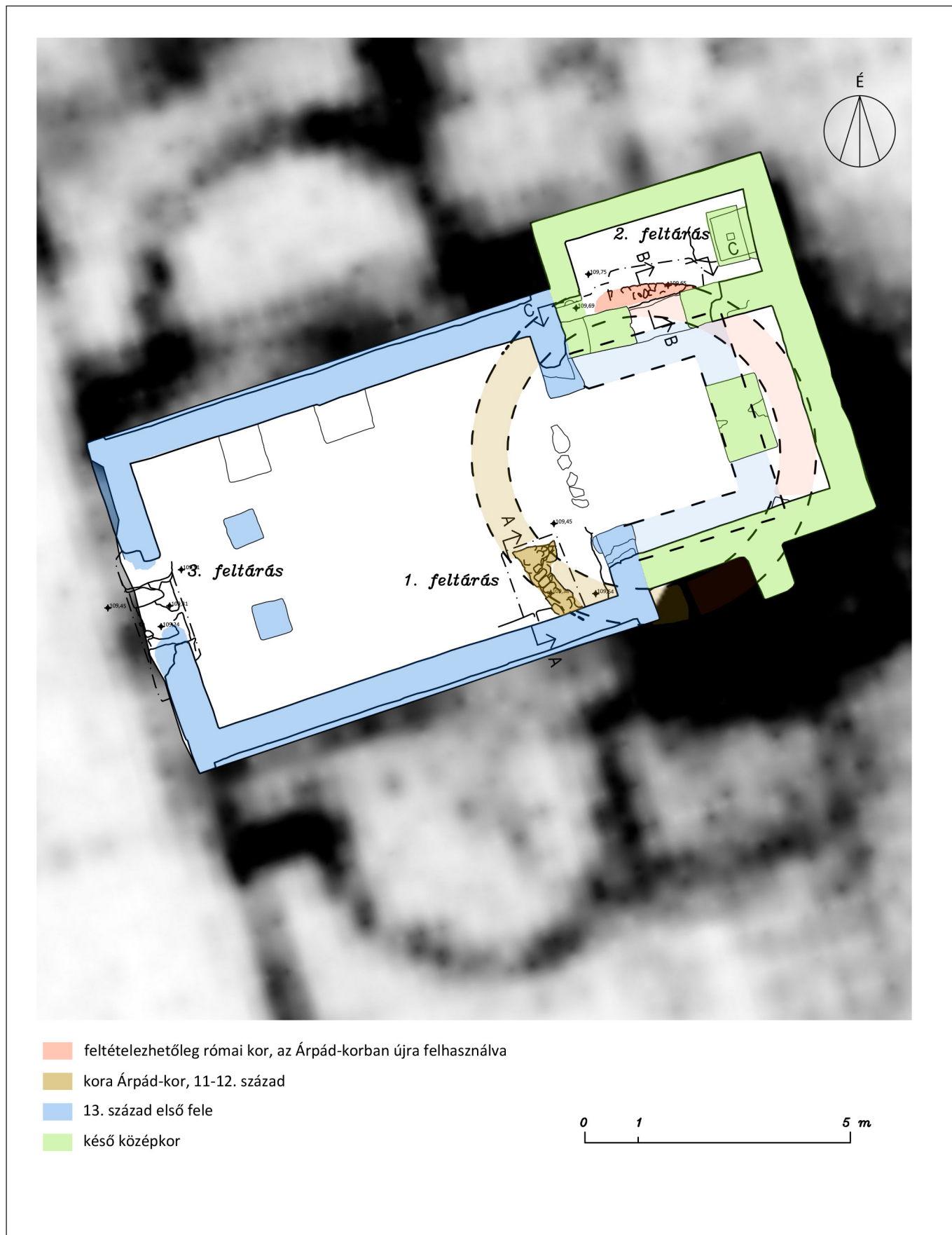
3. kép. Kutatási alaprajz a feltárt alapfalakkal és a templom környezetének talajradaros felmérésével. Épületfelmérés: Kvalitron Kft., Szappanyos Tibor, KÖZTI, Kelemen Bálint; építéstörténeti értelmezés: Rácz Miklós, talajradaros felmérés: Salisbury Kft., STIBRÁNYI & KLEMBALA 2022, méretarány: 1:125
