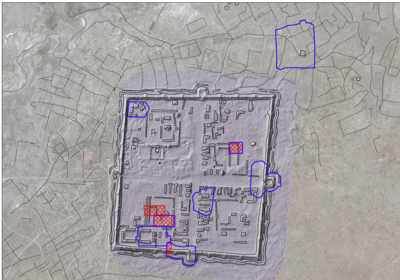
2. kép. A Khar Bukh Balgas erődített településnél végzett talajradaros és elektromágneses ellenállásmérés segítségével dokumentált részek (kék: ellenállás, piros: talajradar)
