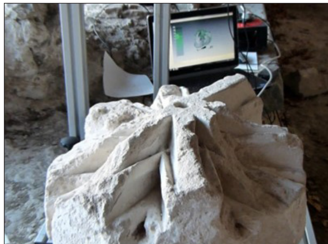
10. kép. Zárókő 3D szkennelése a visegrádi ferences kolostorban
