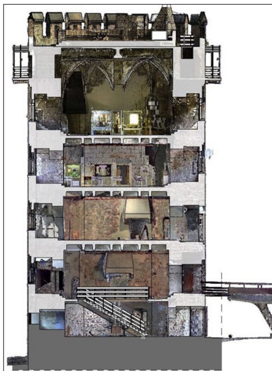
1. kép. Visegrád, Alsóvár-Salamon torony színes pontfelhő keresztmetszete
