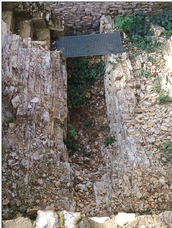
5. kép: A bányáárók alja a szinte függőlegesen álló mészkőrétegekkel, a kibányászott kőzet helyével és az újra teret hódító növényzettel
