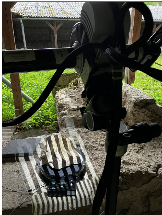
17. kép A kolostor köveinek mérése Breuckmann tárgy szkennerral, 2024-ben (Fotó: Fehér András)
