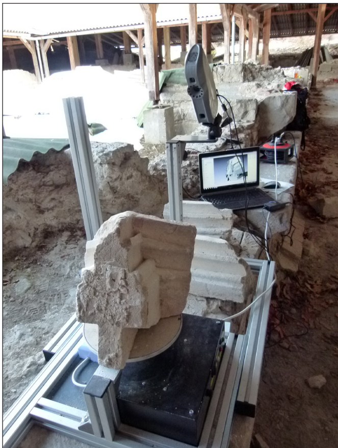
16. kép A kolostor köveinek mérése Eva szkennerral, forgató asztallal 2013-ban (Fotó: Fehér András)
