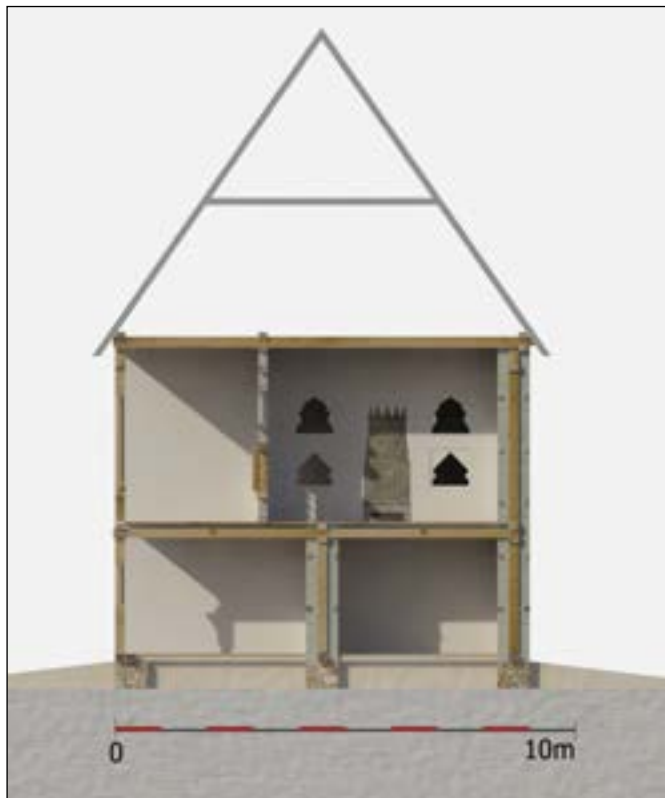
15. kép. A palotaépület rekonstruált keresztmetszete. Szolnok-Vár, 16. század második fele (3D modell: Szőke B.)
