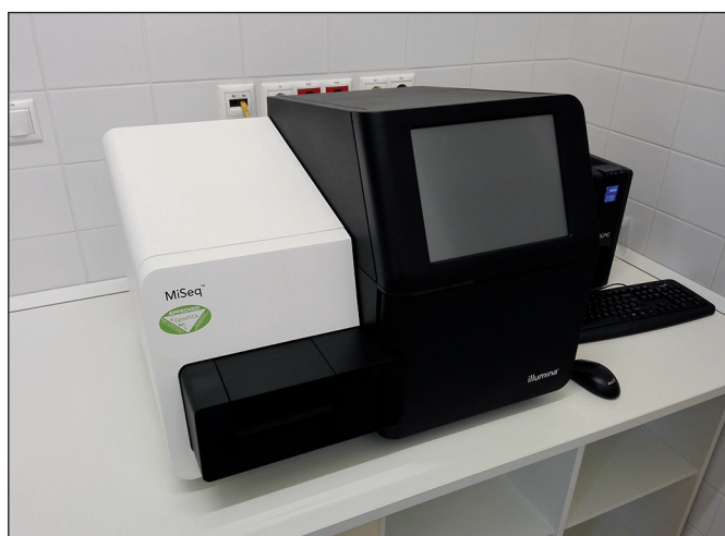
3. kép: Illumina MiSeq szekvenátor készülék
