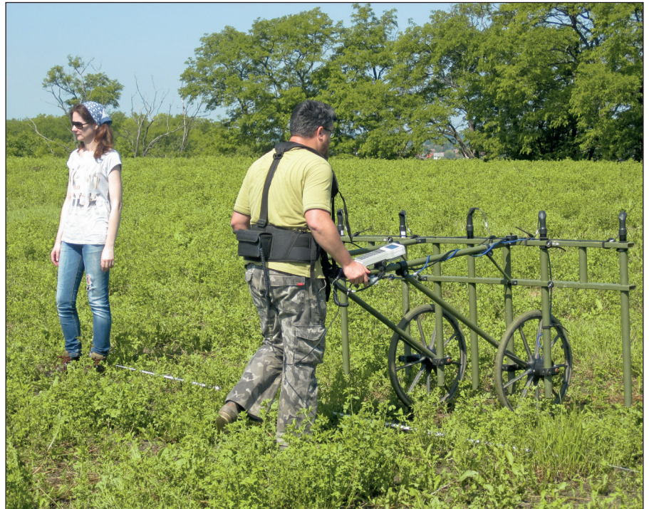
Fig. 8: Geomagnetic prospection in progress at Szécsény-Ültetés
