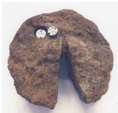
The split iron bloom from the Lábod - Petesmalom site (Somogy County), with the mark of the metallographic sampling / A lábod- petesmalmi (Somogy m.) ékelt vasbuca a metallográfiai mintavétel nyomával
