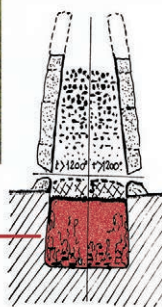
16. kép: A feltárt gyepvasolvasztó kemencék működésének rekonstrukciója
