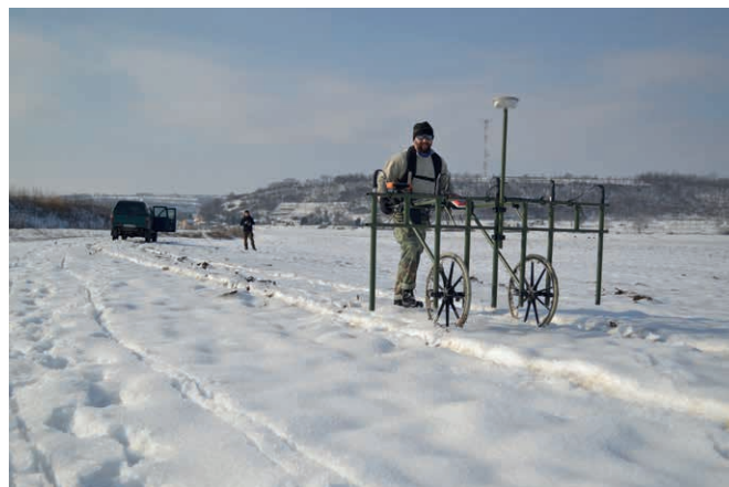
3. kép: Az 5 csatornás magnetométer (SENSYS MAGNETO®-MX ARCH) működés közben (Serlegi Gábor) Alsónyék-Bátaszéken. Szenzorok távolsága 50 cm (fotó: Knut Rassmann)
