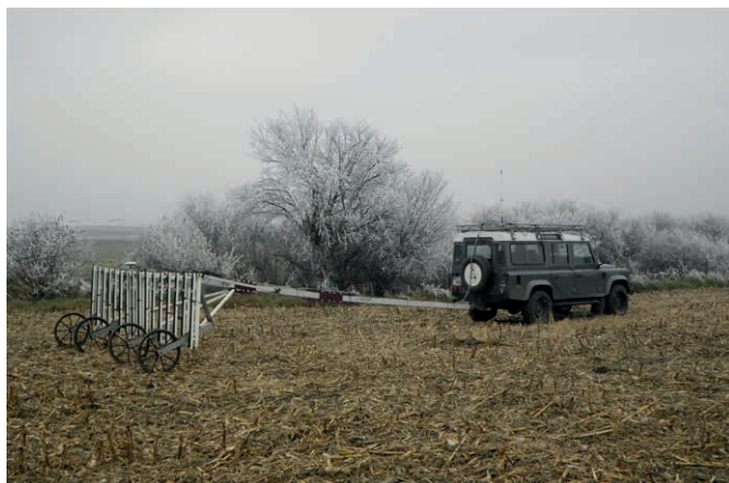
2. kép: A 16 csatornás magnetométer (SENSYS MAGNETO®-MX ARCH) Tolna-Mözsön (fotó: Kay Winkelmann)
