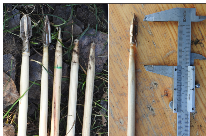
16. kép. A farönkökről lepattant, sérült nyílvevők
