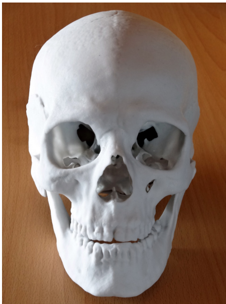
4. kép: A műanyag koponyamásolat készítése RP technológiával (fotó: Major Balázs)
