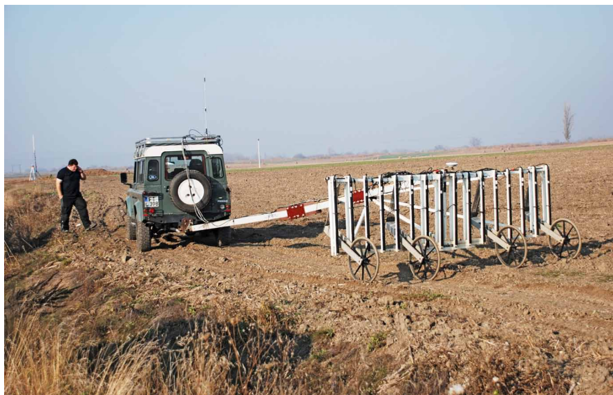
1. kép: Sensys Magneto® MX, tizenhat szenzoros magnetométer az alsónyéki lelőhelyen
