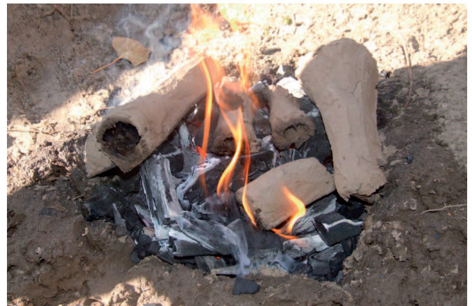
9. kép: A modellek kiégetése a fém olvasztására is szolgáló kemencén, faszéntűzőn
