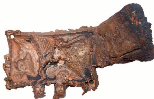
12. kép: A nyers öntvény (használatlan, hibás darab, varratokkal és az öntőforma beágyazóanyagában maradt légbuborékokba folyt fémmel)
