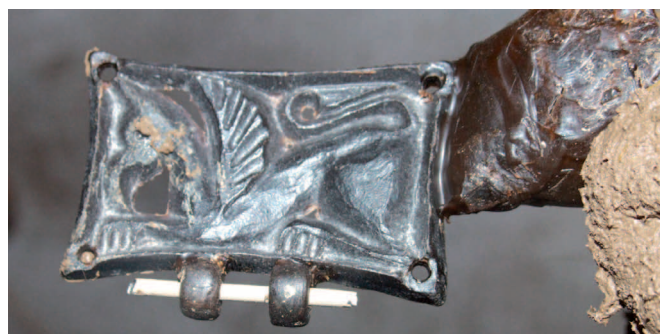
6. kép: Az öntőformába beágyazáshoz előkészített, cizellált viaszmodell a beöntőtölcsér viaszmodelljével és a zsanér lyukaiba dugott, agyaglével (engóbbal) kezelt vasdróttal
