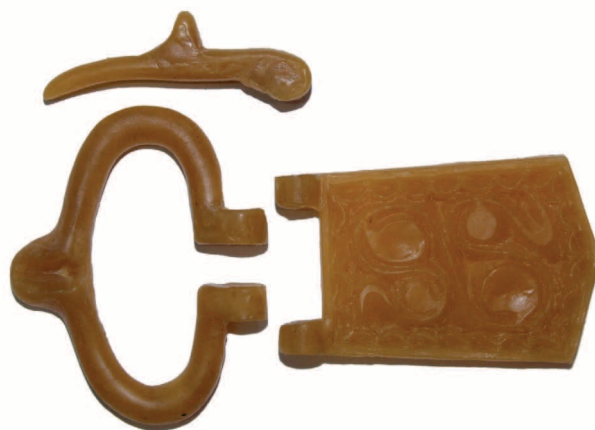
3. kép: Méhviaszból faragott mesterpéldány: csat alkotórészei
