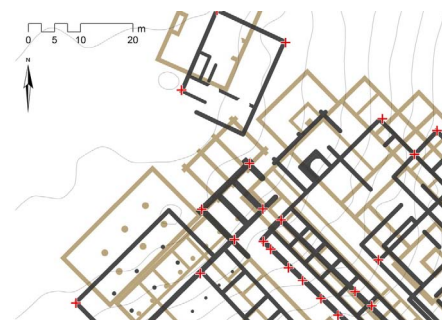
4. kép: A bemért pontok (piros kereszt) segítségével pontosított alaprajz (szürke) a légfelvételek alapján készített alaprajzhoz képest (barna)
